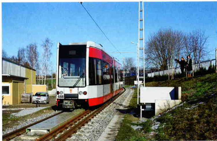
Links: deze tram uit Halle (D) is door Bombardier voorzien van het PRIMOVE-energieoverdrachtsysteem, en kan daardoor op trajecten zonder bovenleiding rijden. De opname toont de tram tijdens een van de testritten op het fabrieksterrein van Bombardier in Bautzen, 22 maart 2009. Rechts: de trams van de Saarbahn in Saarbrücken rijden buiten het stadscentrum op regionale spoorlijnen. Motorwagen 1011 passeert tijdens een proefrit het plaatsje Brebach. Het einde van deze lijn bevindt zich in het Franse grensstation Sarreguemines.
