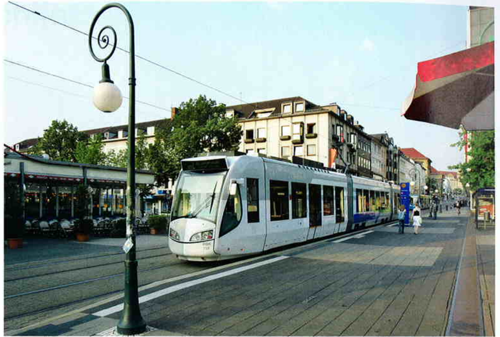
De Königstraße in de binnenstad van Kassel op 25 juli 2006. Hybride Regiotram 759 rijdt hier met de stroomafnemer op. De grote platte doos op het dak is de dieselmotor. Door deze winkelstraat rijden ook een aantal stadslijnen. Alstom Transport
